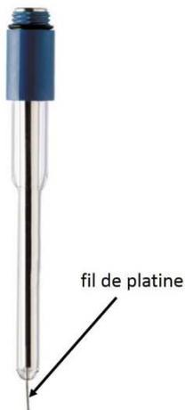
La plus couramment rencontrée est l'électrode de platine : petit fil de platine implanté dans une structure en verre surmonté d'un dispositif de connexion (figure ci-contre). Elle permet d'avoir des informations sur les couples redox dont les deux espèces sont dissoutes en solution, comme par exemple le couple  $\text{Fe}^{3+}/\text{Fe}^{2+}$  :
